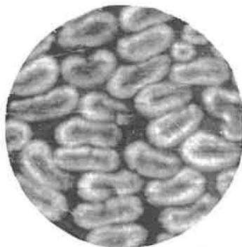
м/ф 12 – поперечний зріз вихідних зразків віскозних волокон ( $\times 400$ )
