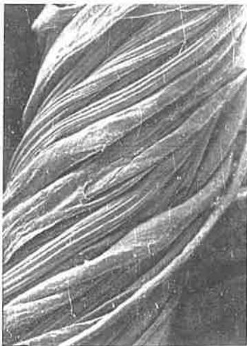
м/ф 1 – вихідний зразок бавовняних волокон
