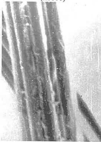
м/ф 11 – окиснений зразок віскозних волокон (18% КГ)
