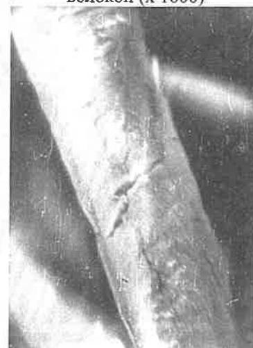
м/ф 4 – окиснений зразок бавовняних волокон (14% КГ)
