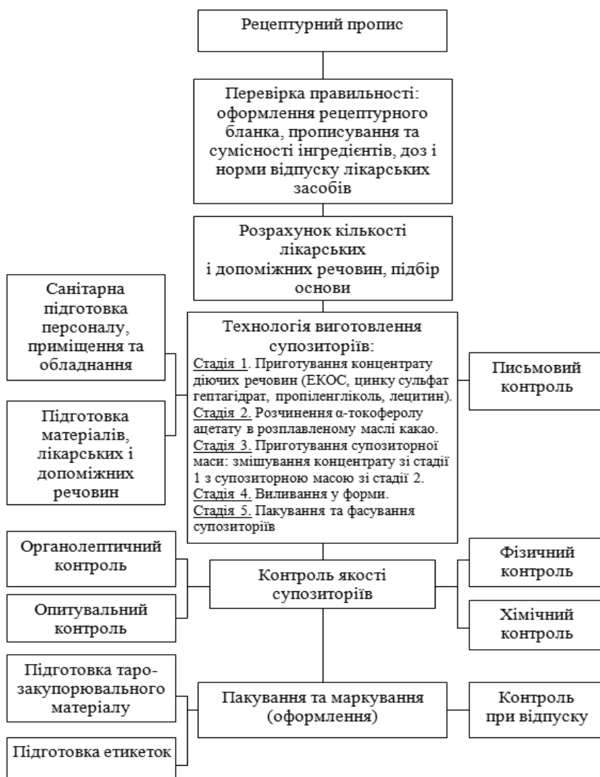
Рис. Блок-схема технології та контролю якості супозиторіїв, виготовлених в умовах аптеки
