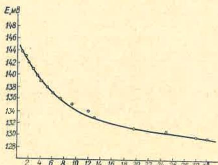
Рис. 3. Вимірювання електродного потенціала у часі в реакції комплексоутворення К-строфантину-β з кальцієм:
